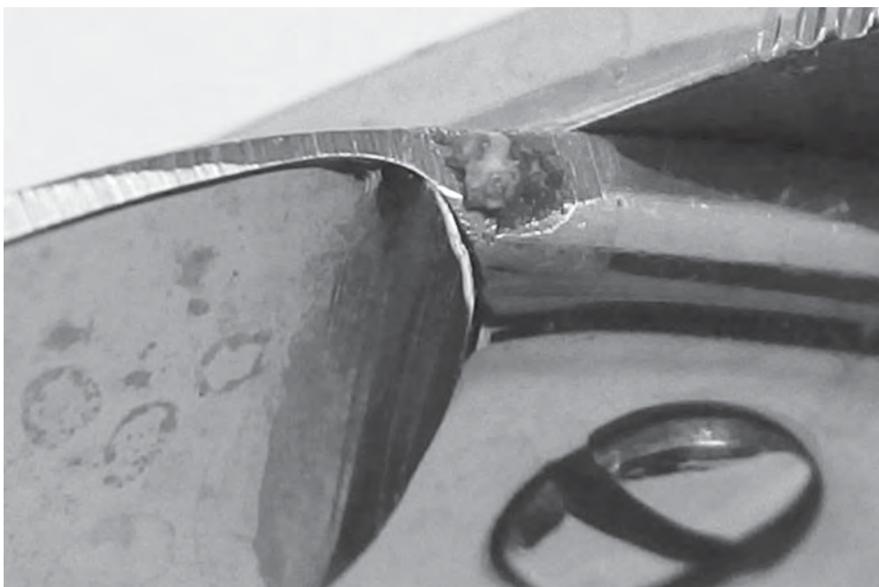
Abb. 8: Medizinprodukt mit Ablagerungen und Korrosion
